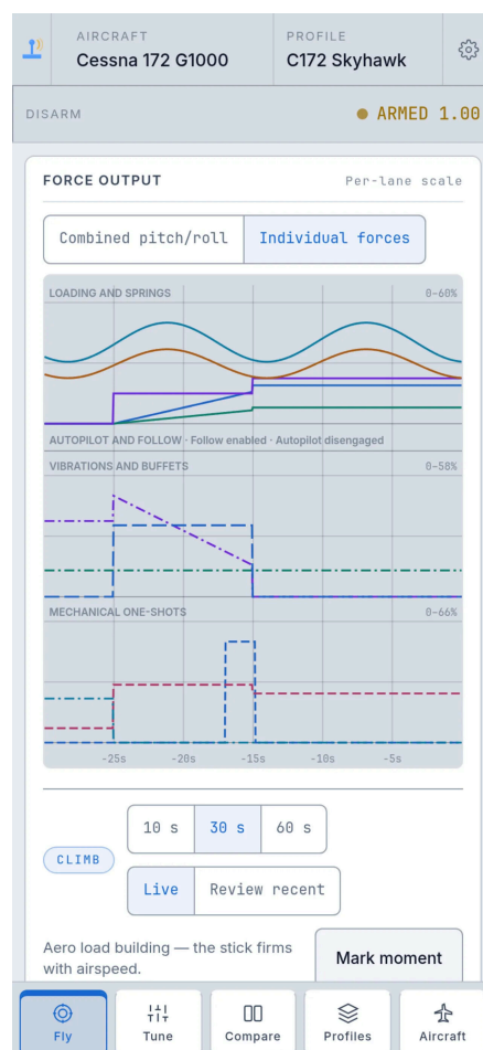
Figure 3. スマートフォンで表示した Cockpit Web。アーム解除ボタンは機体とプロフィールの下にあり、タブは画面の下部に移動します。
