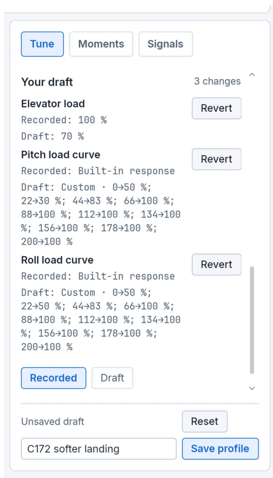
Figure 5. 3つのドラフト変更があるチューニングタブ。エレベーター負荷を 100% から 70% に下げ、ピッチとロールの負荷カーブをカスタムにしています。
