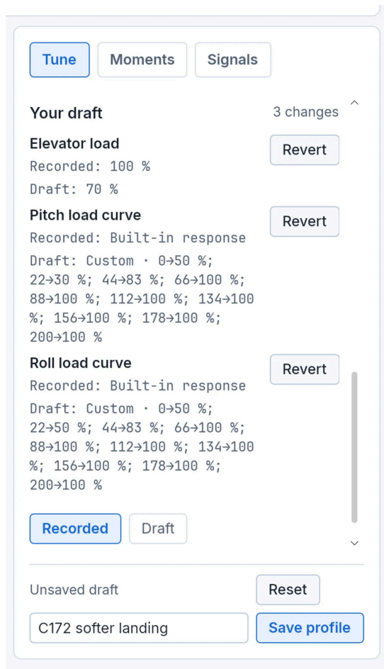
Abbildung 5. Der Tab „Abstimmen“ mit drei Änderungen im Entwurf: Höhenruderlast von 100 % auf 70 % gesenkt sowie eigene Lastkurven für Nicken und Rollen.
